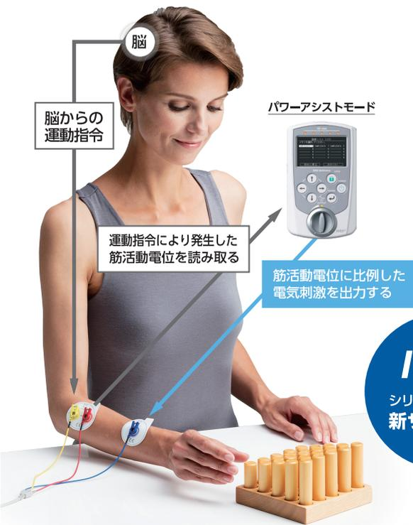
筋肉の動き(筋活動電位)筋電)を検出し、筋電に比例した電気刺激を筋肉にあたえます。
