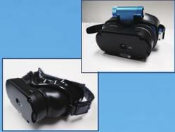
フレンツェル眼鏡に装着する事で、赤外線フレンツェルカメラとして使えます。
